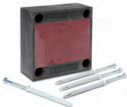
Elemento in schiuma poliuretanic rigida, rinforzato internamente con una piastra d'acciaio e superiormente con una piastra di alluminio iniettata con schiuma per l'avvitamento degli elementi esterni pesanti in facciata senza ponti termici (es. corrimano, ringhiere, tende parasole ecc.).
