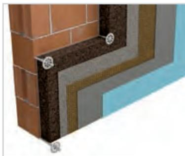
**VARIANTE CON PANNELLO ISOLANTE IN FIBRA DI LEGNO**
