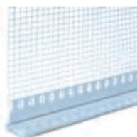
Profilo in PVC con nastro di guarnizione autoadesivo in PE e rete in fibra di vetro impiegato come raccordo sigillante tra il pannello isolante e davanzali di finestre, profili di copertina ecc.
