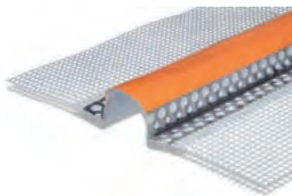
Giunto in PVC con guaina in caucciù sovraverniciabile e rete in fibra di vetro preaccoppiata da inserire tra i pannelli isolanti in presenza di giunti strutturali dell'edificio.
