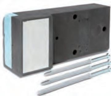
Supporto in schiuma poliuretanic rigida, con incorporate due piastre in resina fenolica da utilizzarsi come supporto per il montaggio senza ponti termici di carichi pesanti (cardini d'imposte, ringhiere, parapetti, ecc.).
