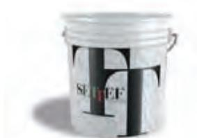
Collante e rasante in pasta a base di resine in emulsione acquosa alcali resistenti, sabbie silicee, inerti micronizzati a granulometria calibrata e additivi specifici da additivare con 1 parte di cemento ogni 2 parti di prodotto. Colore: grigio.
