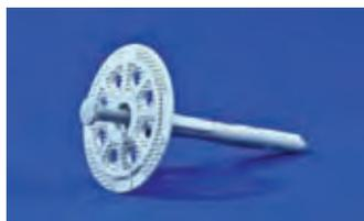
Tasselli ad espansione in polipropilene con chiodo in nylon rinforzato con fibra di vetro, utilizzato per il fissaggio meccanico supplementare dei pannelli isolanti. Omologato secondo ETAG 014 per categorie d'uso B e C. Profondità di ancoraggio: 50 mm.
